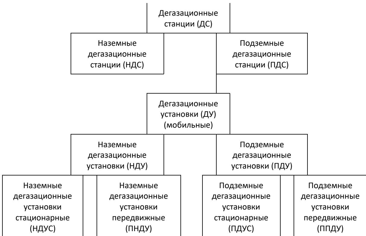
Рисунок 1. Схема ДС (ДУ)
