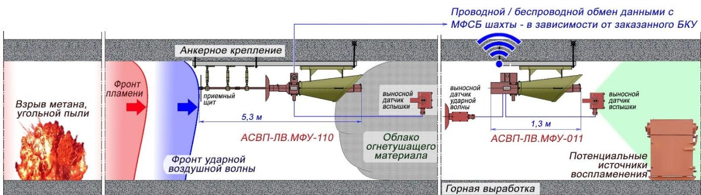
**АСВП-ЛВ.МФУ** может комплектоваться датчиком вспышки метана - единственным в России, специально разработанным для систем ООО «МВК по взрывному делу».
