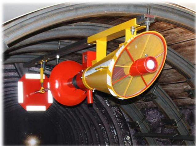
Средство взрывозащиты горных выработок АСВП-ЛВ.1М предназначена для защиты горных выработок от распространения по ним взрывов метановоздушной смеси и (или) угольной пыли, путем создания заслона в виде облака из огнетушащего порошка во взвешенном состоянии. Применяется в шахтах, опасных по газу и разрабатывающих угольные пласты, опасные по взрывам пыли, в качестве взрыволокализирующих заслонов.
