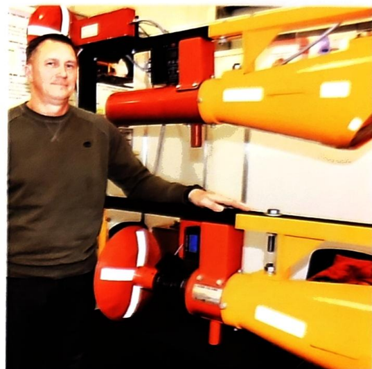
Директор ремонтно-сервисного центра компании «МВК по взрывному делу» Андрей Козлов демонстрирует автоматические системы АСВП-ЛВ.МФУ, на новом уровне обеспечивающие безопасность в горных выработках
