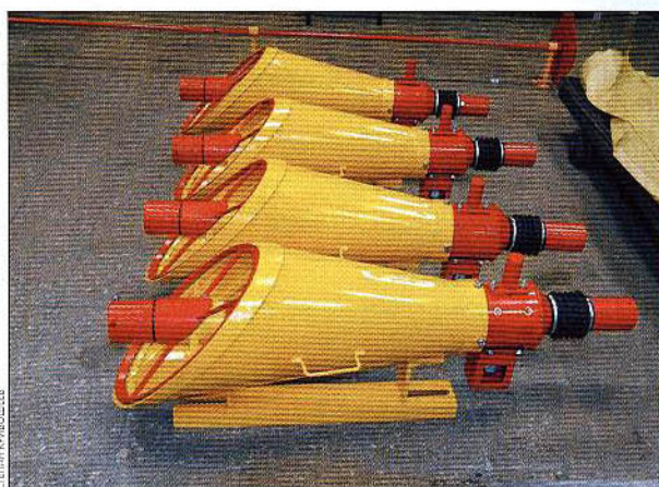
РАЗРАБОТАННАЯ В ИНСТИТУТЕ ГОРНОГО ДЕЛА ИМ. А. А. СКОЧИНСКОГО УСТАНОВКА ЛОКАЛИЗАЦИИ ВЗРЫВА МЕТАНА МОЖЕТ СПАСТИ СОТНИ ШАХТЕРСКИХ ЖИЗНЕЙ. ВВЕРХУ: УСТАНОВКА, ПРИКРЕПЛЕННАЯ К ПОТОЛКУ ШАХТЫ
