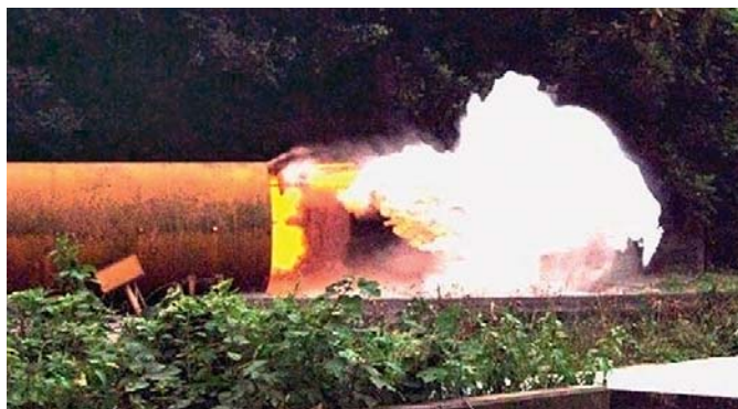
Срабатывание АСВП-ЛВ.1М и начало распыления огнетушащего порошка перед распространяющимся фронтом пламени
