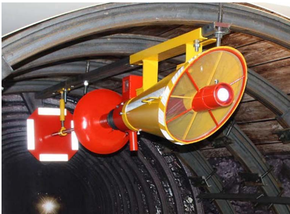
Рис.3.7. Внешний вид автоматической системы взрывоподавления-локализации взрывов типа АСВП-ЛВ(.1М)
