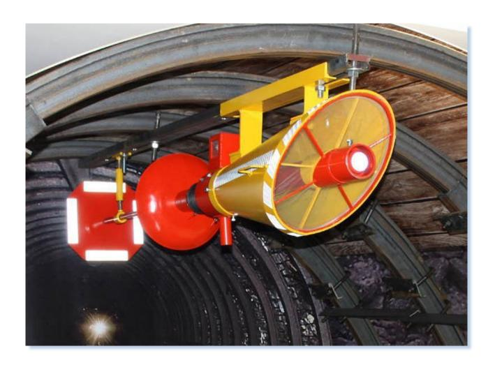
Применяется на территории России, стран Таможенного союза, в подземных выработках угольных шахт в качестве взрыволокализующих заслонов в составе системы контроля и управления средствами взрывозащиты горных выработок
