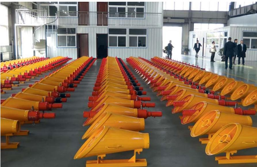
**Серийное производство автоматических систем взрывоподавления-локализации взрывов АСВП-ЛВ.1М на заводе в провинции Шандун (Китай)**
