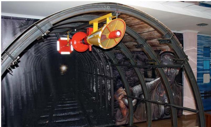
**Стенд автоматической системы взрывоподавления-локализации взрывов АСВП-ЛВ.1М на выставке в Технопарке г. Кемерово**
